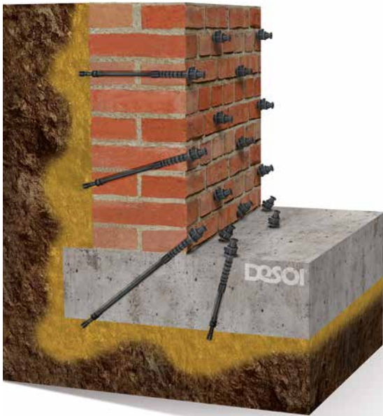
Schleierinjektion | Curtain injection
